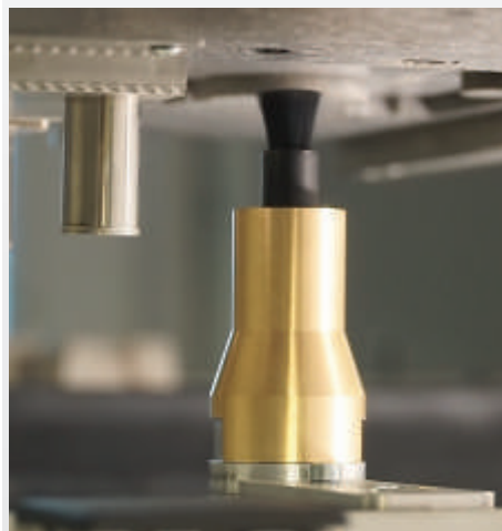
Automatisches Bürst-System integriert im Prozessraum
