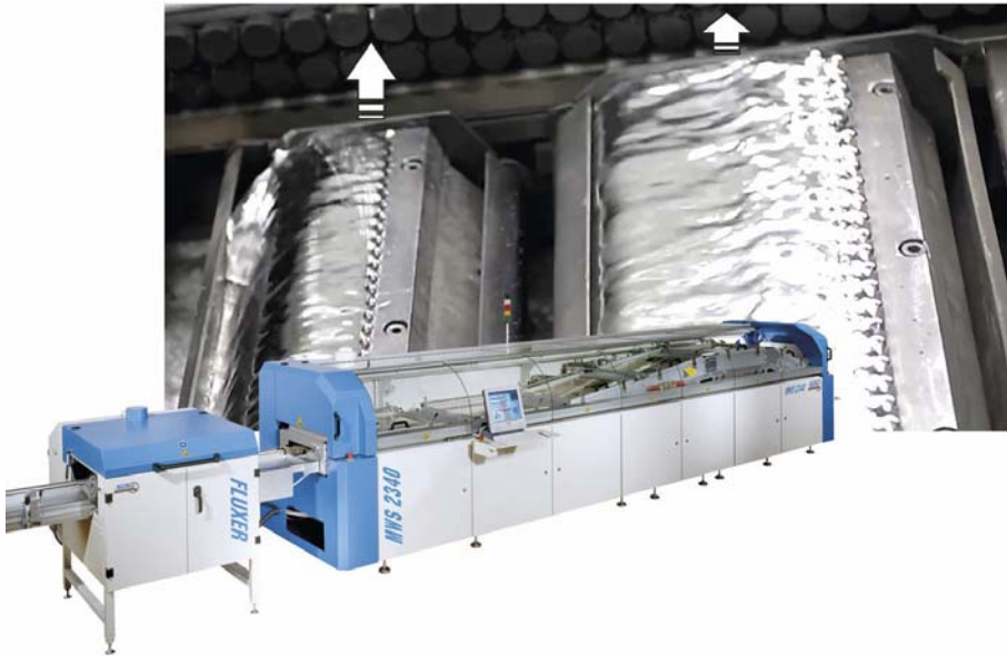
Bild 2: Die automatische Düsenhöhenverstellung garantiert eine sichere Benetzung, auch bei der Bearbeitung von anspruchsvollen Baugruppen in Lötmasken.
