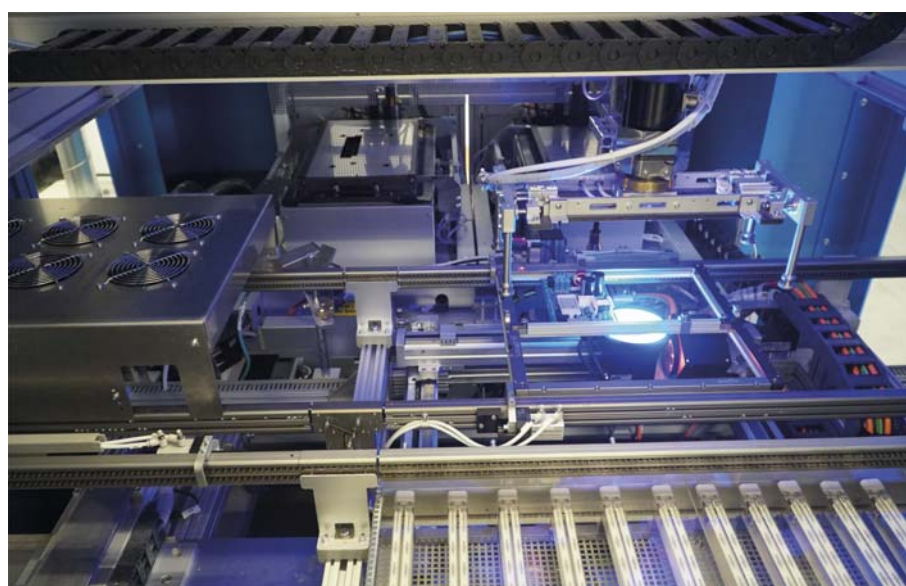
Bild 5: Null-Fehler-Fertigung: PowerVision AOI-System integriert im Selektivlötprozess.
