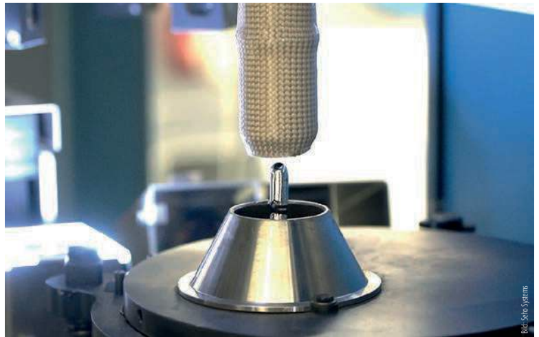
Die automatische Ultraschallreinigung für benetzte Lötdüsen sorgt für einen sicheren Prozess und erhöht die Anlagenverfügbarkeit.
