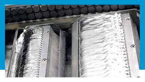
Automatische Düsenhöhenverstellung. In bis zu 16 verschiedenen Sektoren einer Baugruppe können die Lötdüsen softwaregesteuert einzeln in der Höhe verstellt werden, um produktabhängig immer den optimalen Abstand zwischen Leiterplatte und Lötdüse zu haben. Das ist maximale Flexibilität und maximale Prozesssicherheit!
