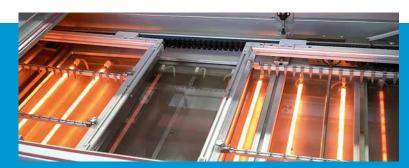
**Pulsar-Vorheizung.** Innovation made by SEHO. Die Pulsarvorheizung von SEHO steckt voller intelligenter Power und ermöglicht so den kosten- und energieeffizienten High Mix-High Volume Wellenlötprozess.
