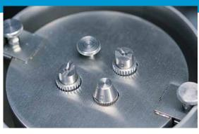
**SEHO SelectFlux**. Selektiver Flussmittelauftrag im Wellenlötprozess. Ihr Vorteil? Minimaler Verbrauch und nahezu keine Verschmutzung.
