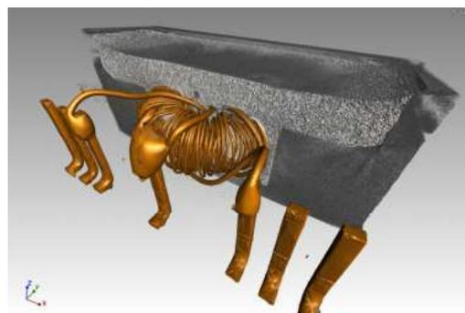
Fehlerhafter Verguss → Eindringen von Feuchte bewirkt Korrosion und Ausfall
