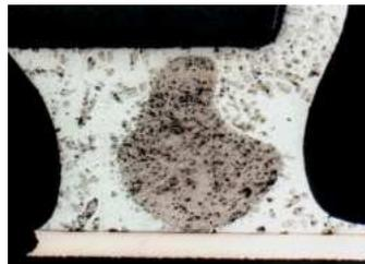
Riss im Glaskörper einer Diode
