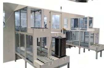
Vollautomatisierte Be- und Entladezelle mit integrierter Inspektion
